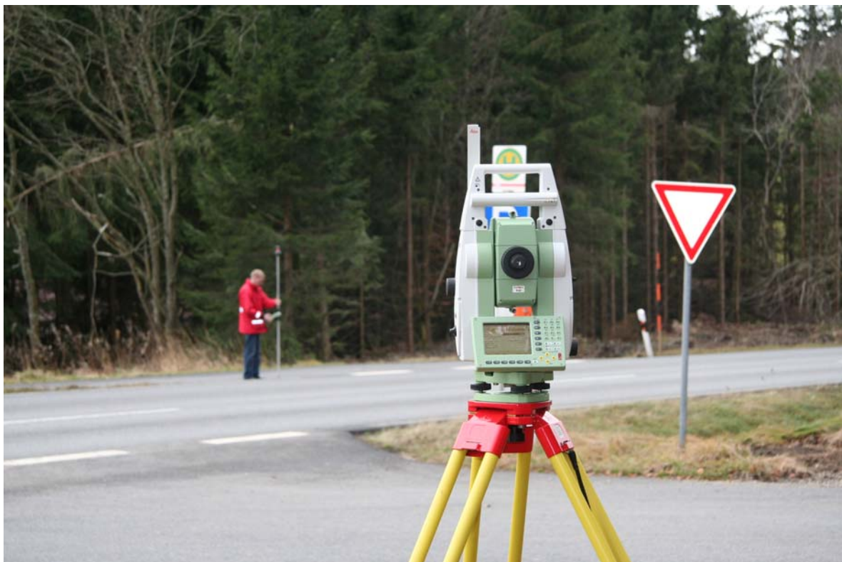
Bild 1: Einsatz einer Theodolitenmeßstation bei der Unfallstellenvermessung
